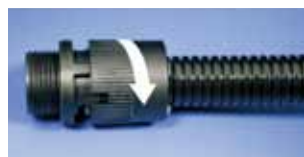
步骤3 旋转迫紧环即可固定浪管
